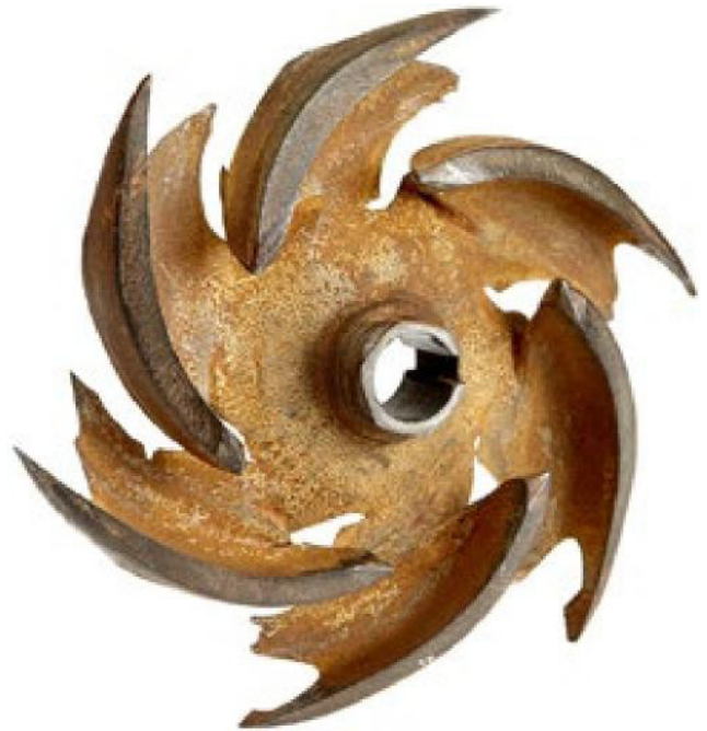
Waaier na een versnelde slijtagetest in een laboratorium.
