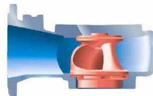
Figuur 1: Voorbeeld van een eenkanaalswaaier
