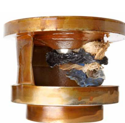
Figuur 4: Ophopingen in een eenkanaalwaaier
