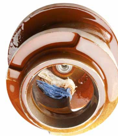
Figuur 5: Ophopingen in een eenkanaalwaaier
